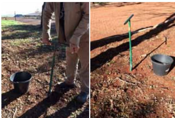
Figura 2. Uso de trado de solo, equipamento utilizado para coleta de amostras de solo para análise química. Fonte: EMBRAPA,1997.
