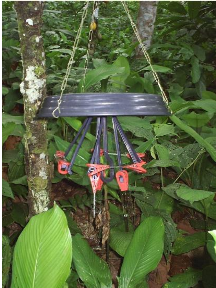
Figura 2 – Coletor artesanal utilizado para amostragem de esporos fúngicos transportados pelo ar. Na figura observa-se o prato invertido sobre a estrutura que contém os pregadores (vermelhos), bem como as três lâminas horizontais (presas por dois pregadores) e as três verticais (penduradas por um pregador); as correntes suspendem o coletor, fixando-o em um ramo da árvore.
